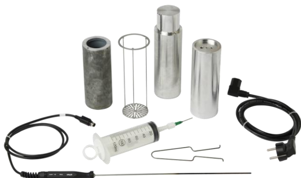
Fig. 5: Accessori necessari per le diverse applicazioni del calibratore multifunzione
