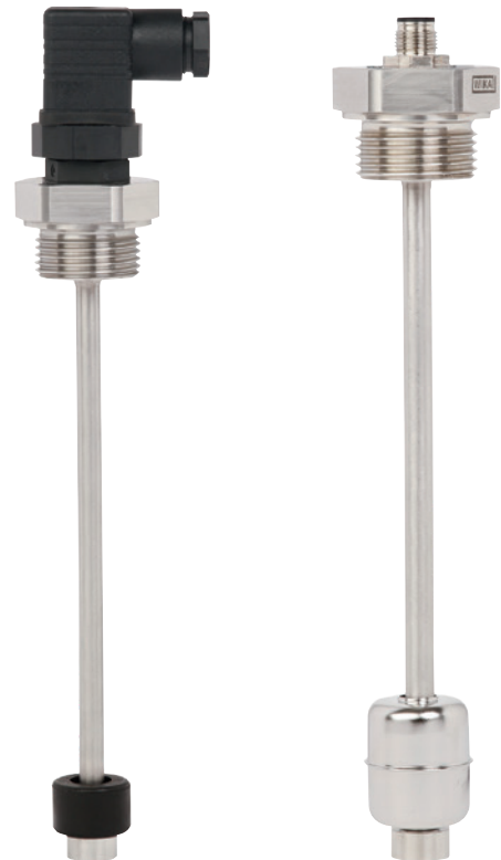
Imagen izquierda: Rosca para montaje desde el exterior, conector angular, flotador de NBR Imagen derecha: Rosca para montaje desde el exterior, conector redondo M12 x 1, flotador de acero inoxidable
