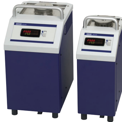
Micro banhos de calibração de temperatura Fig. esquerda: Modelo CTB9100-165 Fig. direita: Modelo CTB9100-225
